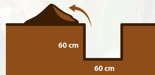
La dimension standard est de 60 x 60 x 60 cm. S'il y a une dalle calcaire, il est recommandé de briser la croûte et aller jusqu'à 1 mètre de profondeur.
